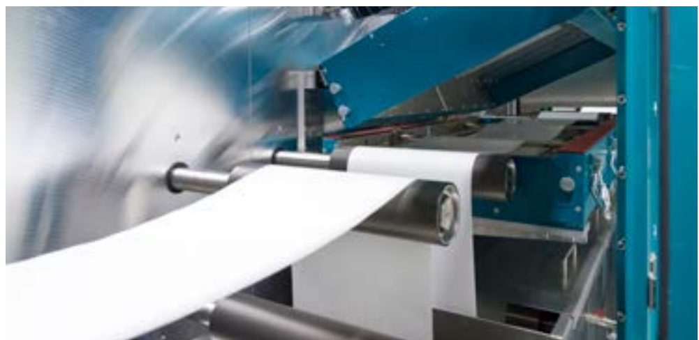
Coatemala-Anlage: R2R-Strukturierung mittels Kalandereinheit
