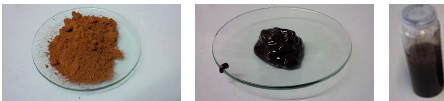
Abbildung 105: Unmodifiziertes Lignin (rechts) in Polyol einsipergiert bzw. gelöst (Mitte, rechts)
