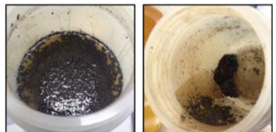
Abbildung 97: Vergleich der Spaltproduktsuspensionen nach der Fällung und der BCD-Oligomer-Phasen nach der Trennung bei verschiedenen Depolymerisierungsbedingungen
