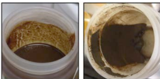
Abbildung 97: Vergleich der Spaltproduktsuspensionen nach der Fällung und der BCD-Oligomer-Phasen nach der Trennung bei verschiedenen Depolymerisierungsbedingungen
