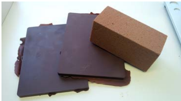
Abbildung 107: Halbhartes Integralschäume und Formteile auf Basis von 30% Lignin
