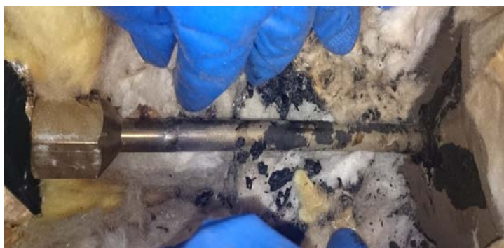
Abbildung 99: Eduktaustritt an der Anlage durch Korrosion, CT-Analyse des Hochdruckrohres
